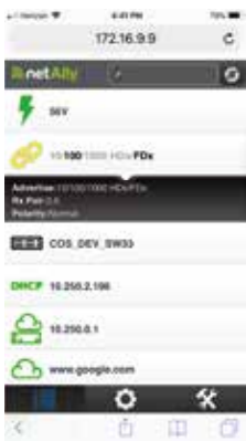
LinkSprinter 配置为以 1 Gbps 速度 进行测试，但只能以 100 Mbps 速度连接
